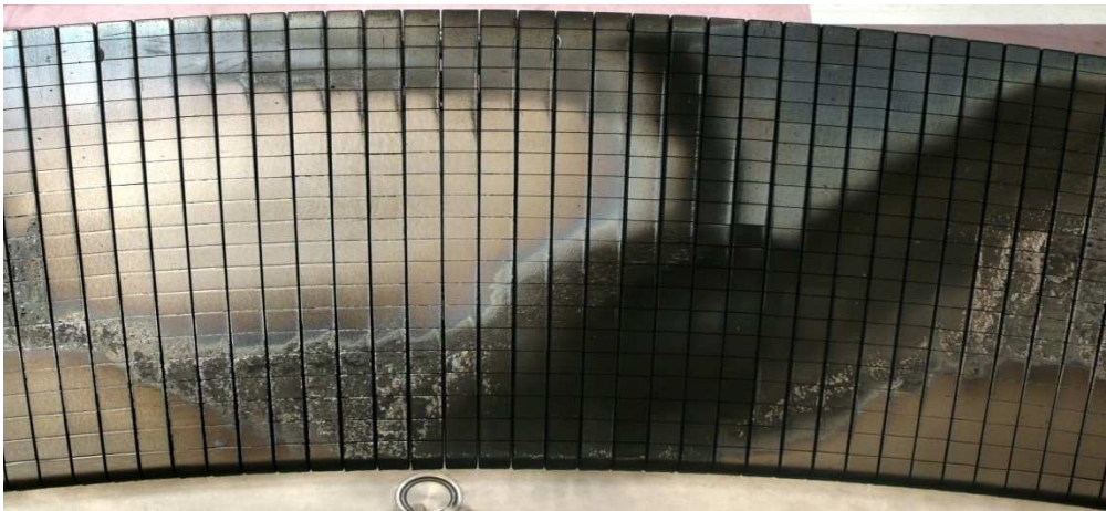
Figure 5 : Photographie de la section de 20° du LPT de TS démontée au cours de DITS. Les zones claires et brillantes sont des zones d'érosion, les zones grises et d'aspect rugueux sont les zones de dépôt épais, les zones sombres et d'aspect plus lisse sont les zones de dépôt fin.
