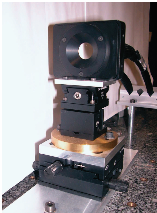
FIGURE 4.10 – Photo du MD^{sol} sur son support mécanique. On peut voir les câbles d'alimentation branchés derrière le MD et maintenus sur un support pour réduire les contraintes.
