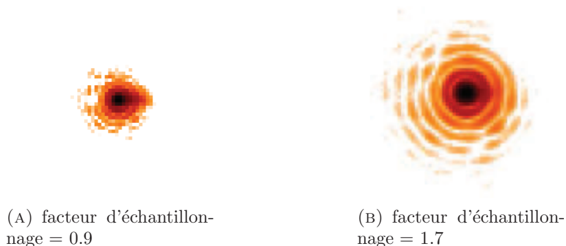
FIGURE 4.27 – FEP obtenues sur tensions d'offset (le MD remplacé par un miroir plan), visualisées en échelle logarithmique. A gauche, la caméra imagerie est sous-échantillonné et à droite, sur-échantillonné. Dans les deux cas, on visualise l'élongation s'étendant sur environ 7 pixels.
