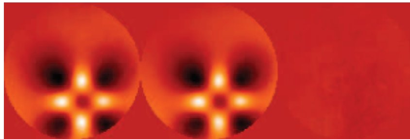
FIGURE 4.13 – Linéarité spatiale du MD^{sol} . Exemple de la réponse du miroir sous l'effet de l'excitation des moteurs 36,37,38,46,47,48,56,57 et 58 par une intensité de 0.02 A. A gauche, le front d'onde généré par excitation simultanée de ces moteurs. Au centre, le front d'onde généré par sommation des fonctions d'influence de ces moteurs, et à droite, la différence entre les deux fronts d'onde, essentiellement du tip tilt.
