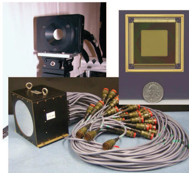
FIGURE 1.11 – Différentes technologies utilisées pour la fabrication de MD. En haut à gauche : le miroir déformable de type magnétique de HOMER comprenant 88 actionneurs. En haut à droite : un MD de type MOEMS comprenant 4086 actionneurs (Courtesy S. Cornelissen, Boston Micromachines Corp.). En bas : le miroir déformable de type SAM pour l'OA extrême de SPHERE, constitué de 1377 actionneurs (Courtesy J.-C. Sinquin, CILAS).
