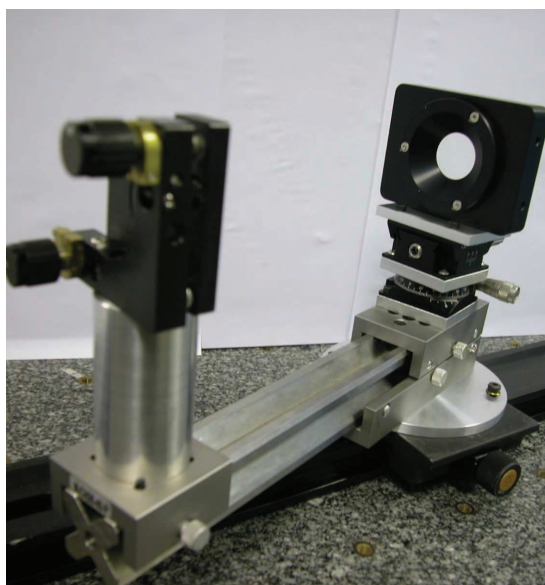
FIGURE 4.17 – Photo du MD^{alt} sur son support mécanique et le rail de translation (les câbles venant normalement alimenter le MD par l'arrière sont débranchés). Le miroir à droite au premier plan est un miroir de renvoi.
