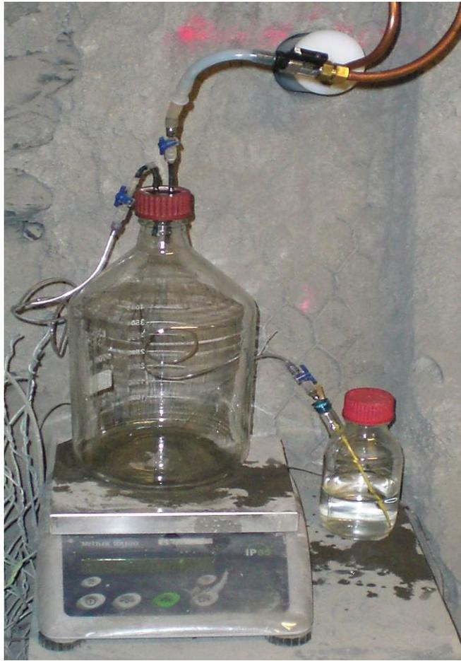
Figure 13 : Dispositif de récupération de l'eau interstitielle du forage KEY1001 anaérobie et stérile
