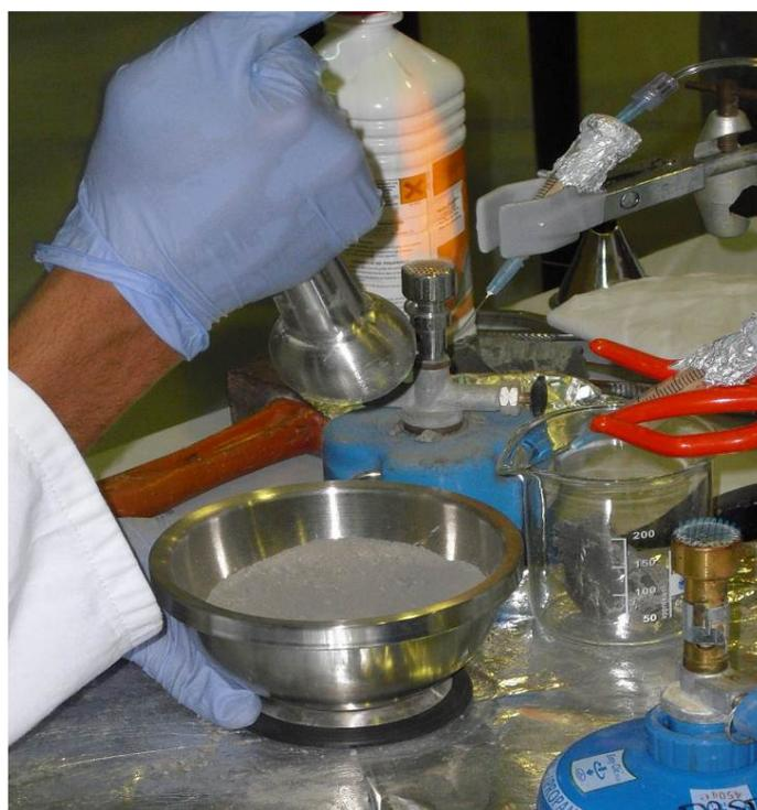
Figure 16 : Illustration du broyage du cœur de carotte par mortier/pilon)
