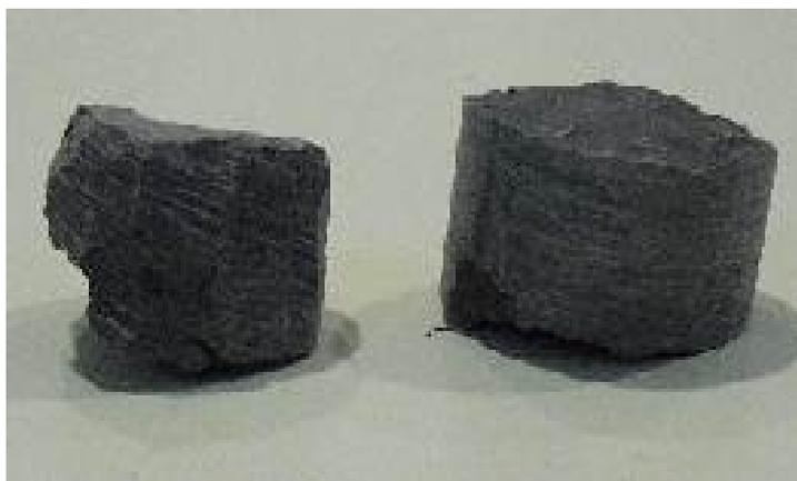
Figure 15 : Différence entre un cœur de carotte (gauche) et une section de carotte non élaguée (droite)
