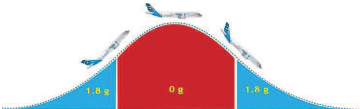
Figure 7 : décomposition de la trajectoire parabolique décrite par l'Airbus A300 Zero-G (tirée de http://www.novespace.fr/fr,vol,technique.html )
