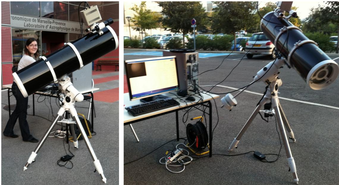
FIG. 3.13 – Photographie du télescope de Newton "Skywatcher" 254/1200 mm sur sa monture équatoriale EQ6 installé devant le Laboratoire d'Astrophysique de Marseille pour observer la Lune. Le module IRXCORE640 est fixé dans son boîtier protecteur beige clair au plan focal du télescope, et la console permettant de contrôler le détecteur est posée sur la table à proximité du télescope.
