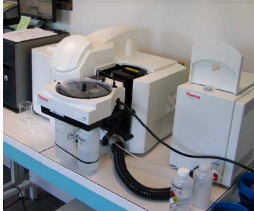
Figure 2.8. AAS Thermo Scientific, ICE 3400. L'échantillon en solution est positionné sur un passeur d'échantillon, un bras automatisé prélève la solution et l'introduit dans le four où l'atomisation se produit.
