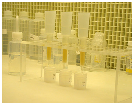
Figure 2.11. Etape de purification sur colonnes jetables. Les flacons Savillex standard sont placés sous la colonne afin de récupérer l'élément élué.
