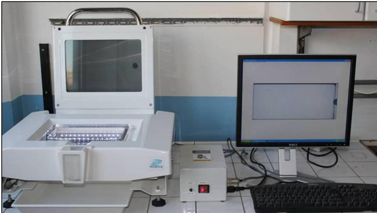
Figure I.4 Système d'analyse d'image composé d'un scanner adapté, le ZooScan, couplé avec un PC équipé du logiciel ZooProcess.
