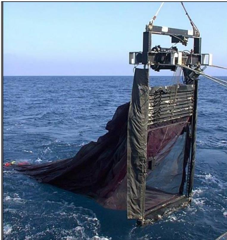
**Figure I.2 Multiple Opening/Closing Net and Environmental Sensing System (MOCNESS) équipé de 9 filets présentant une ouverture de 1 m<sup>2</sup>.**
