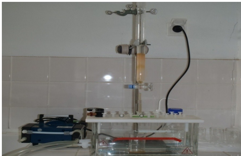
Figure 33 : Dispositif mis au point pour le fractionnement des parties du fruit de l' Oenocarpus bataua
