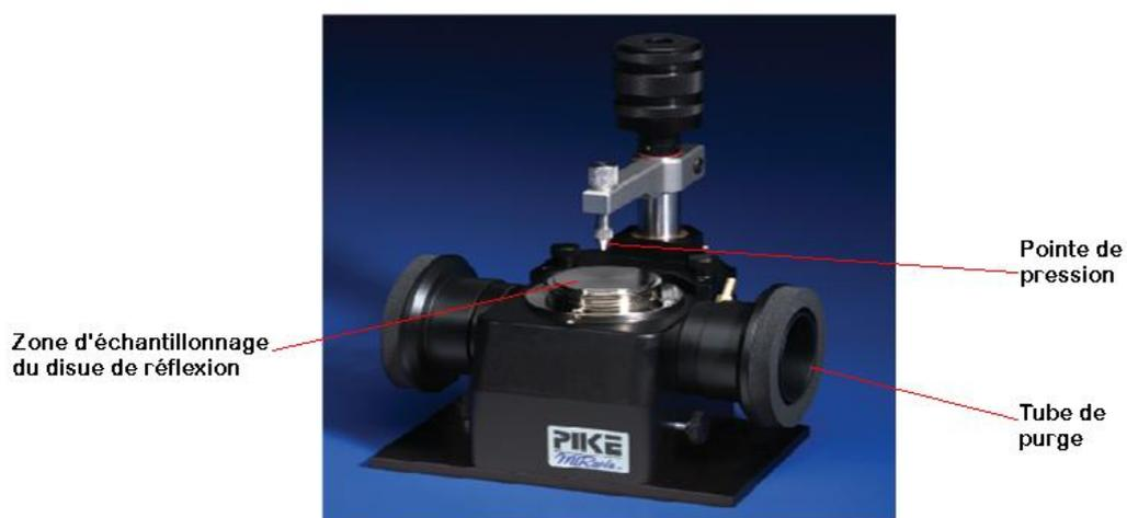
Figure 11b : Dispositif ATR utilisé
