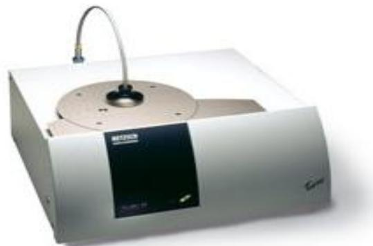
Figure 16 : L'appareil utilisé dans notre laboratoire (TG 209 F3 Tarsus)
