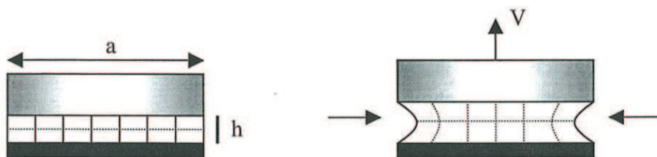
Figure I-60 : Sollicitations d'un adhésif lors de la traction effectuée par la sonde.
