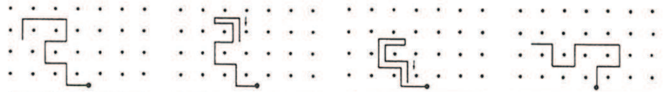
Figure I-17 : L'image de de Gennes de la "reptation" des étoiles, la branche doit retourner à son point d'attache pour renouveler sa configuration.
