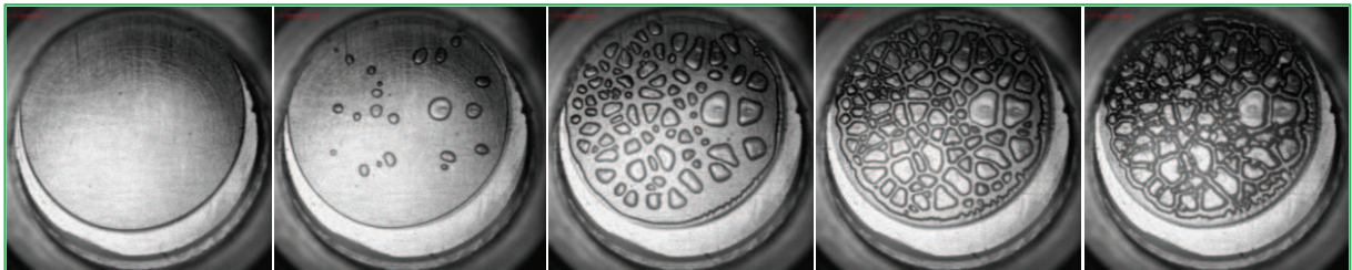
Figure III-51 : Images des différentes étapes lors du décollement de la sonde pour le PE350 (vitesse de décollement = 0.1 \text{ mm.s}^{-1} ).
