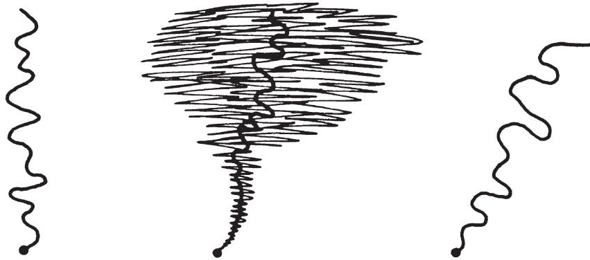
Figure I-18 : Processus de relaxation de la branche par fluctuation de ses extrémités selon Mac Leish.
