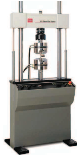
Fig. 3-2 : machine hydraulique MTS 810
