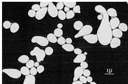
Fig. 1-20 Observation au microscope du latex : concentration de masse de caoutchouc de 37% dans une suspension aqueuse (Soustelle, 1955)
