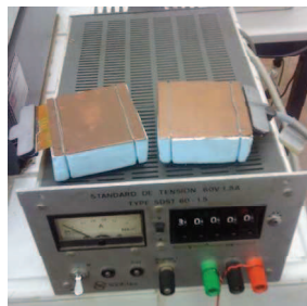
Figure 4-2 : Générateur de courant et « plans chauds »
