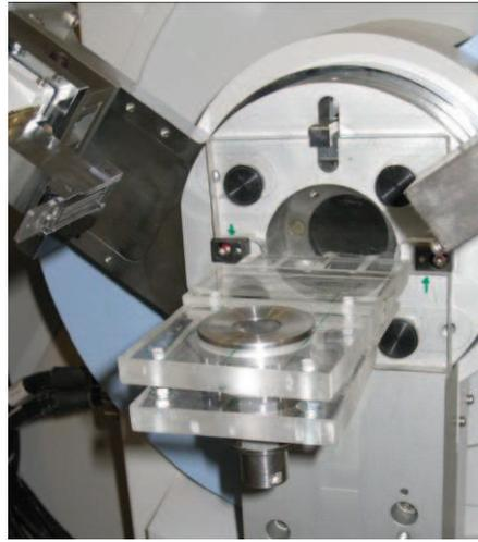
**Figure 135 : Montage expérimental du diffractomètre X pour les études *in situ operando***
