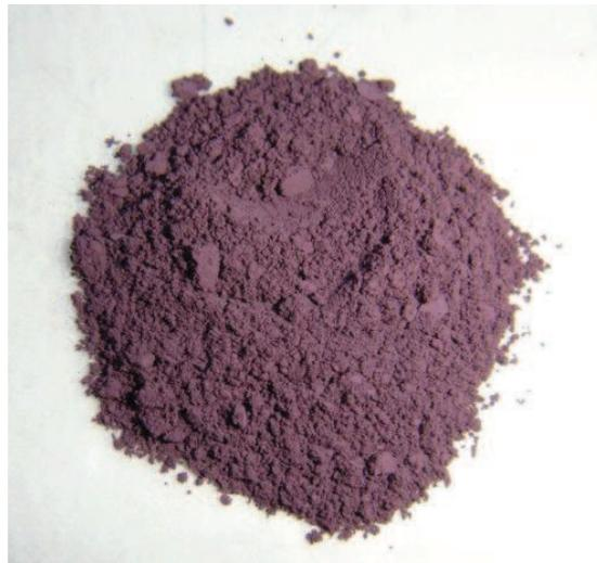
Figure 80 : Photo de la poudre  $\text{Fe}_{0,5}\text{Mn}_{0,5}\text{PO}_4$  obtenue par oxydation chimique
