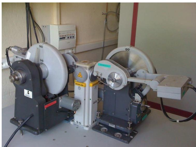
**Figure 171 : Goniomètres Philips avec anticathode de cobalt**
