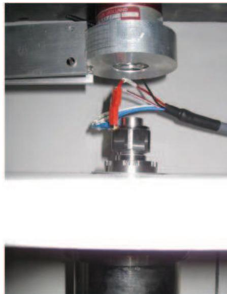
**Figure 136 : Montage expérimental du spectromètre Mössbauer pour les études *in situ operando***
