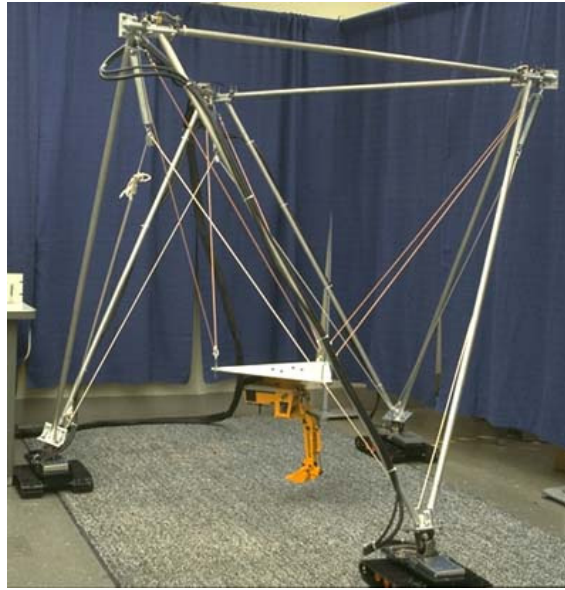
FIGURE 1.5 - Une version du NIST Robocrane : un des premiers robots parallèles à câbles suspendus.
