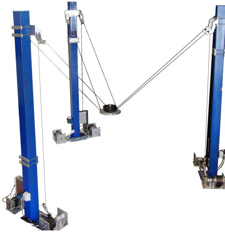
FIGURE 1.11 - Le démonstrateur ReelAx6 : un robot à câbles suspendu reconfigurable à 6 câbles et 6 DDL.
