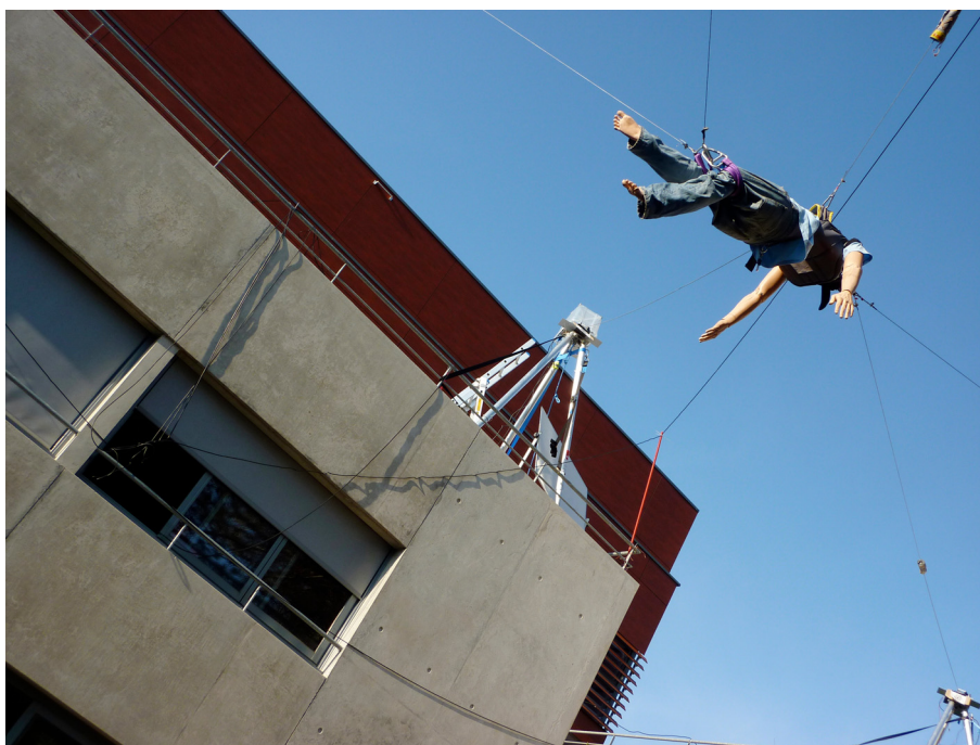
FIGURE 1.6 - Le démonstrateur de l'INRIA (INRIA, Sophia-Antipolis, France) : un robot parallèle à câbles utilisé pour le secours de personne en milieu accidenté.
