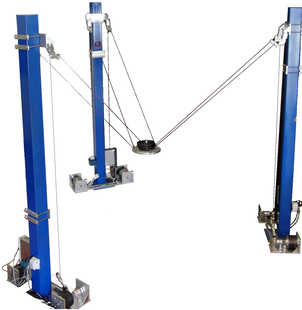
FIGURE A.1 - Le démonstrateur ReelAx6, un robot parallèle à 6 câbles et 6 DDL reconfigurable.
