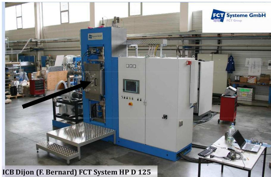
FIG. 3.1 – Procédé « Frittage Flash » (FCT Systeme GmbH, HP D 125) étudié et modélisé dans ce mémoire. Le système est localisé au laboratoire interdisciplinaire Carnot de Bourgogne (ICB), de l'Université de Bourgogne à Dijon.
