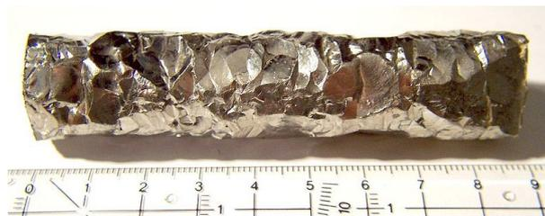
**FIGURE II.1 :** Barre de Zirconium cristallisé pur à 99.97% obtenue par Procédé Van-Arkel-de-Boer.
