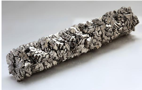
**FIGURE II.2 :** Barre de Titane cristallisé pur à 99.97% obtenue par Procédé Van-Arkel-de-Boer.
