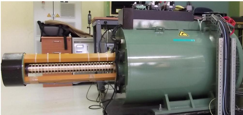
Figure 1.32 – Maquette avec les détails des bagues collectrices
