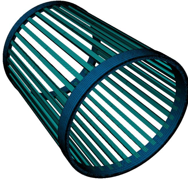
Figure 3.17 – Le maillage des barres amortisseur en bleu clair avec les anneaux qui les referment en bleu foncé
