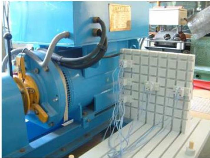
Figure 1.6 – Turbogénérateur d'essai avec les capteurs de flux [9]
