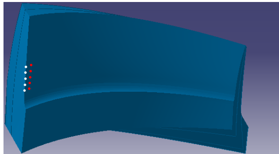
Figure 97 : Portées à vide initiales sur le pignon sans et avec déplacement.
