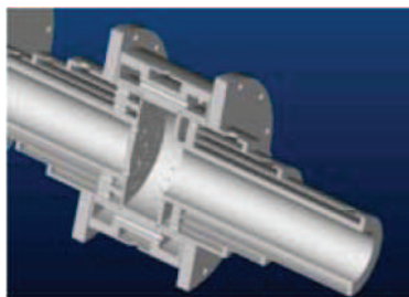
FIGURE 7.6: Schéma du TVC proposée par le laboratoire national d'énergie et de technologie (NETL) couplant une cavité et une zone pilote RQL [353].
