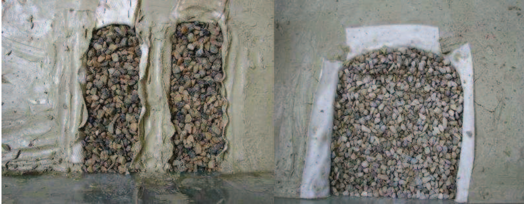
FIG. 4.7 – Vue en plan de la partie supérieure des CMM et du matelas granulaire continu des IR
