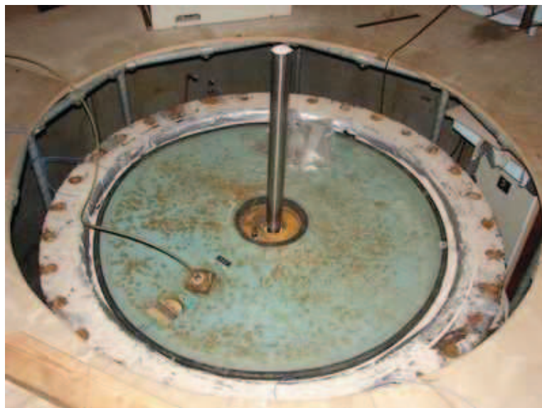
FIG. 3.5 – La membrane supérieure de la chambre d'étalonnage
