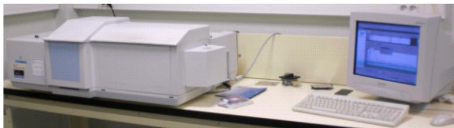
FIGURE 4.16: Spectrophotomètre Lambda 900.
