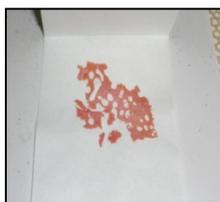
Figure III - 10 : Photographie d'une membrane RIP PEEK-S-OH/OFHDA de proportion massique 50/50 sous forme acide
