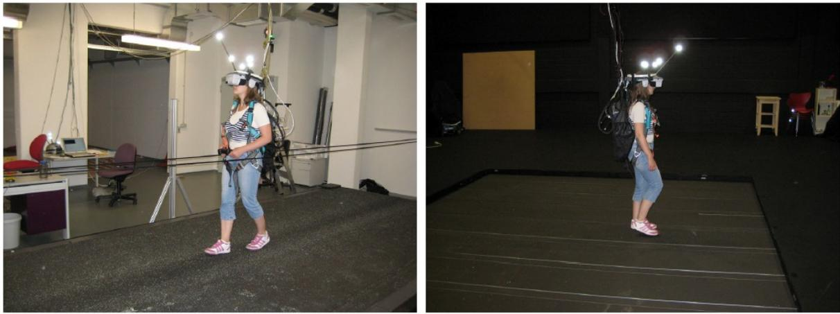
Figure 3.8 : (Ruddle et al.,2011). A gauche, marche physique sur un tapis roulant unidirectionnel et visualisation de l'EV avec HMD. A droite marche physique sur un tapis omnidirectionnel. Les boules blanches sur les deux images correspondent au tracking de position et de tête à l'aide la motion capture.
