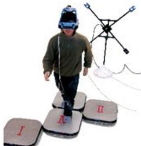
Figure 2.10 : le système CirculaFloor, , Iwata et al. (2005) , Université de Tsukuba, Japon.
