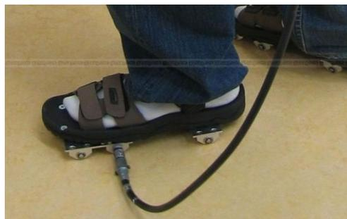
Figure 2.9 : Le système Powered Shoes, Iwata et al. (2006), Université de Tsukuba, Japon.
