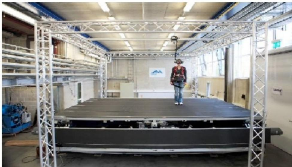
Figure 2.14: le tapis omnidirectionnel CyberWalk©.
