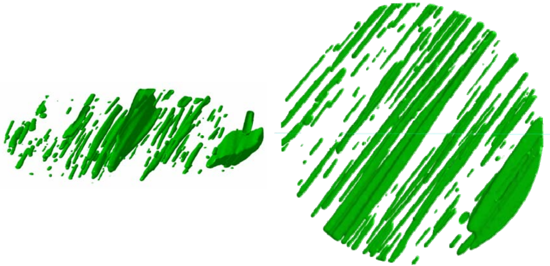
figure II-32 : Porosités à l'interface des couches \pm 45^\circ et 90^\circ dans la zone 2 en perspective et en vue de dessus
