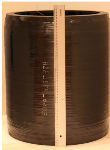
figure II-1 : Photographie de la virole du réservoir de diamètre intérieur 310mm et d'épaisseur 40mm avec une règle de 50cm
