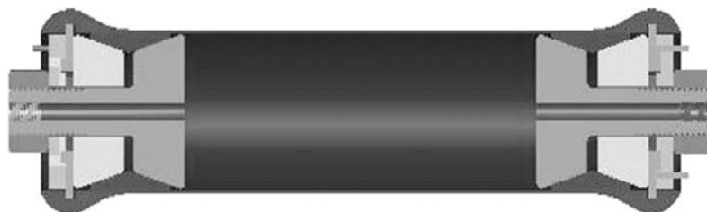
figure I-25 : Dispositif de mise sous pression interne d'un tube avec introduction d'un effet des fonds artificiel [Onder et al, 2009]
