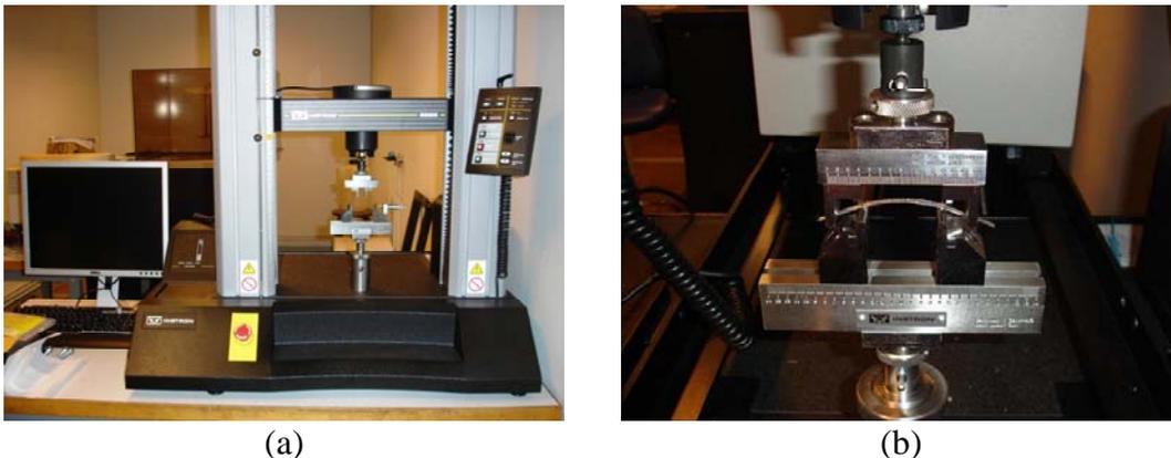
**Figure 4.16 (a) Dispositif expérimental de flexion quatre points (b) Lamelle sous chargement de flexion**
