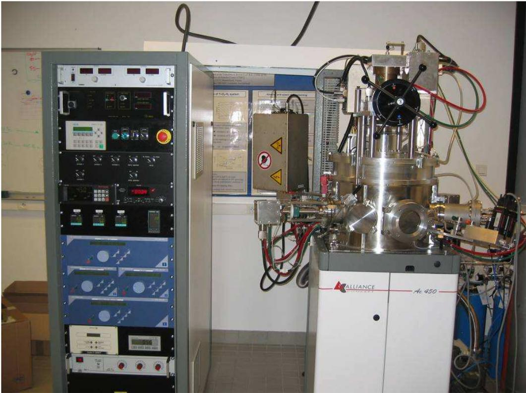
*Figure AI.6* : Machine de pulvérisation cathodique à magnétron.
