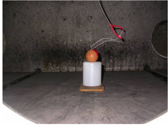
Figure B4 Gauche : dispositif de rétention de 15 litres d'eau (création d'une flaque partielle) – Droite : charge sphérique de TNT de 150 g et mise en place de la ligne de mise de feu.
