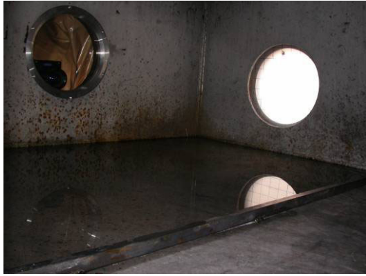
Figure B4 Gauche : dispositif de rétention de 15 litres d'eau (création d'une flaque partielle) – Droite : charge sphérique de TNT de 150 g et mise en place de la ligne de mise de feu.
