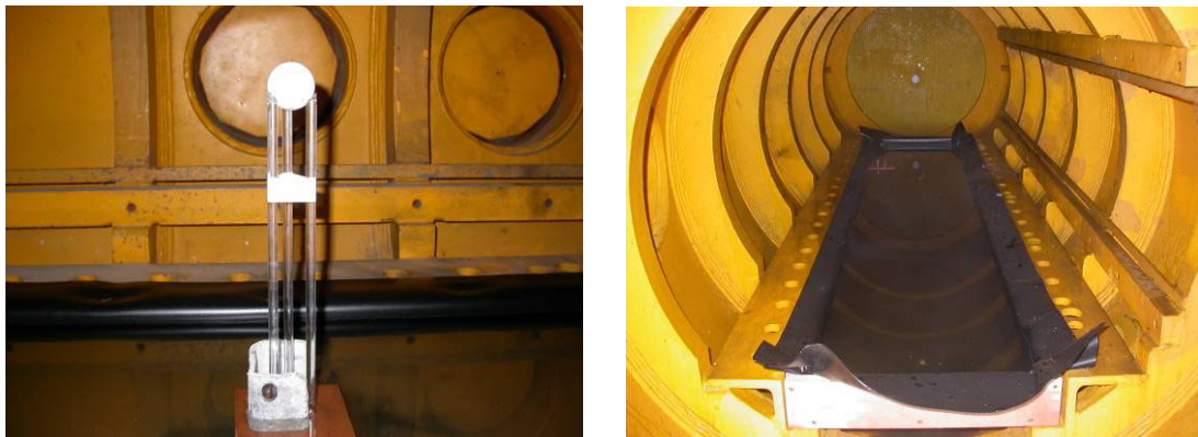
Figure B 7 Vues intérieures chambre Athéna - gauche : mise en place d'une charge sphérique – droite : bac de rétention simulant une flaque de liquide / plancher de travail
