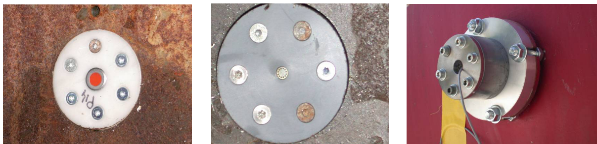
Figure B15 Fixations en paroi des capteurs de surpression interne – gauche : capteur PCB avec protection thermique – milieu : capteur résistif – droite : douille de montage externe
