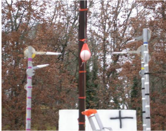
Figure C2 Gauche : Mise en place de la sphère d'explosif – Droite : sphère usinée et son puits d'amorçage
