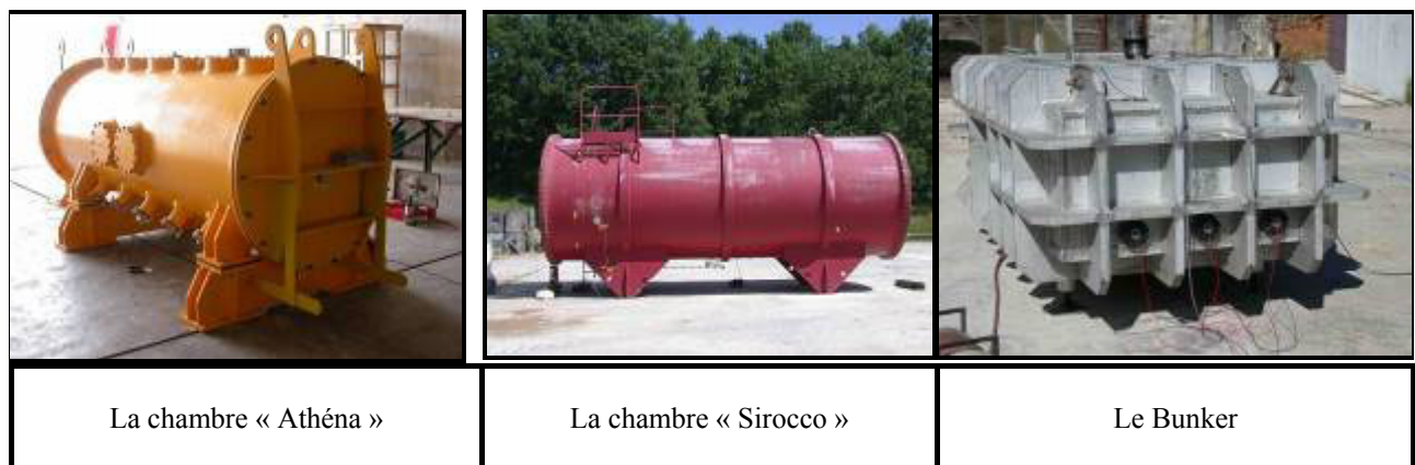
Figure II.21 Vues d'ensemble des trois chambres de tir du CEA Gramat
