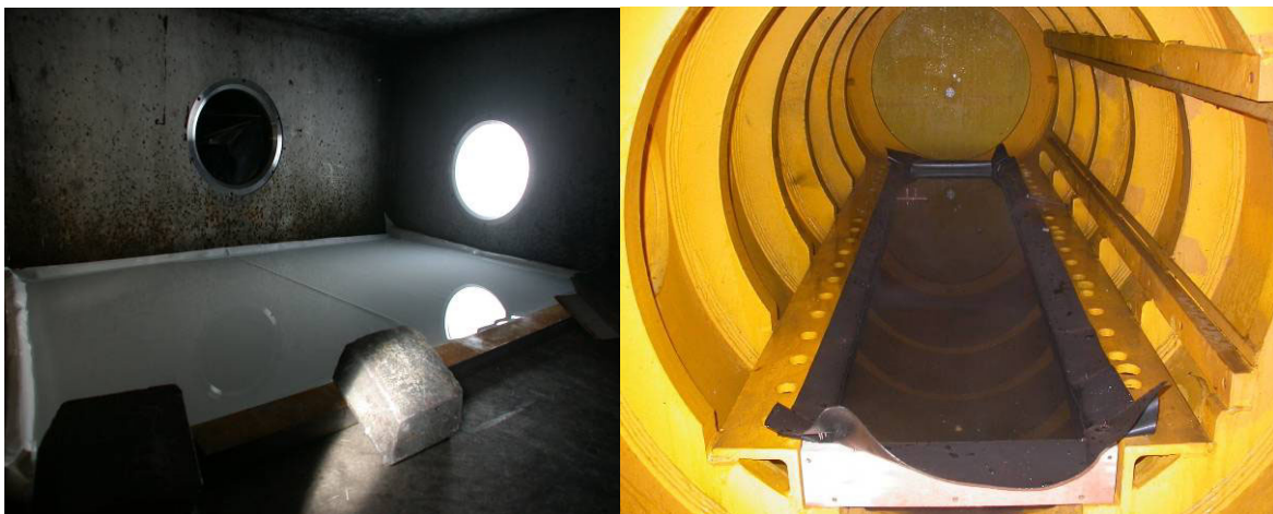
Figure II.79 Expérimentations DMC en présence d'eau sous forme de flaque- à gauche, flaque sur 1/3 de la surface au sol du bunker – à droite, bac à l'intérieur de la chambre Athéna
