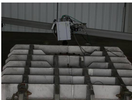
Figure B3 Gauche : Hublot supérieur pour visualisation et ouverture calibrée – Droite : points de mesure de surpression interne et système de fixation des capteurs
