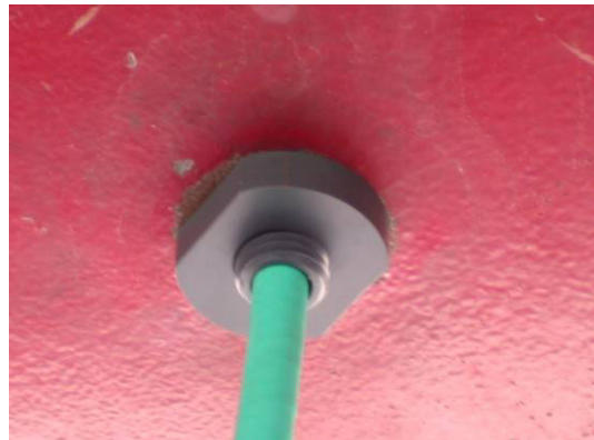
Figure B13 Système d'amorçage de la charge explosive par cordeau détonant – gauche : partie de raccordement finale – droite : passage du cordeau à travers la paroi de la chambre
