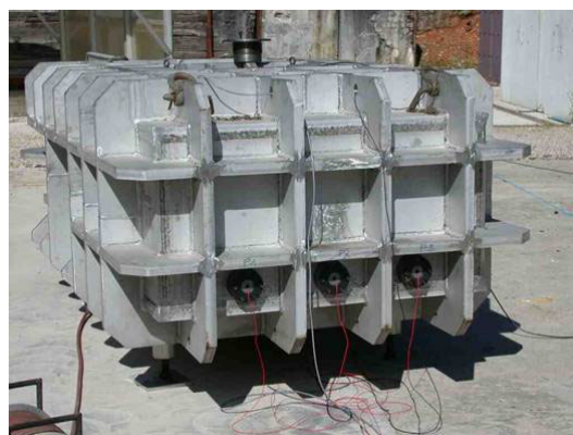
Figure B3 Gauche : Hublot supérieur pour visualisation et ouverture calibrée – Droite : points de mesure de surpression interne et système de fixation des capteurs
