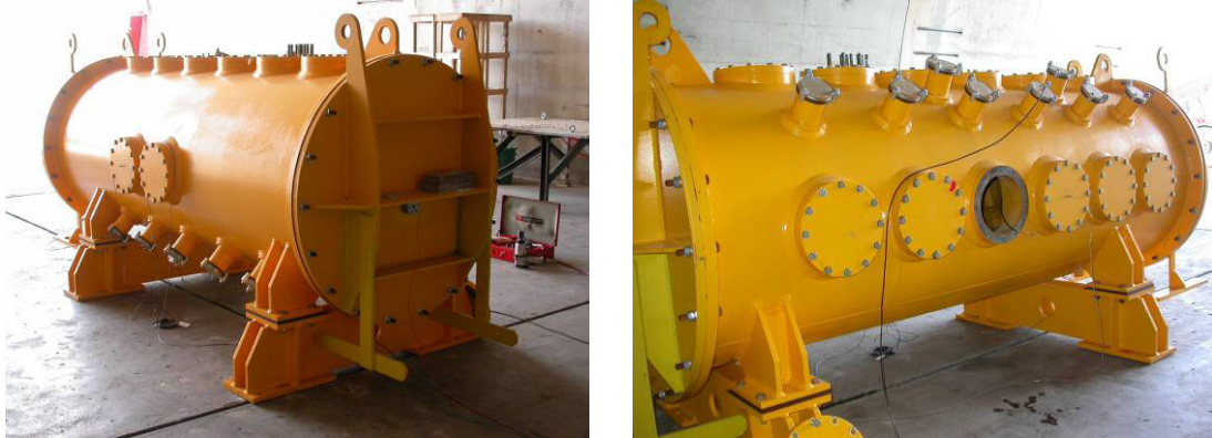
Figure B 6 Vues extérieures de la chambre Athéna : à gauche : têtes de fermeture – à droite : hublots amovibles et prises d'air pour passage de la ligne de mise de feu.
