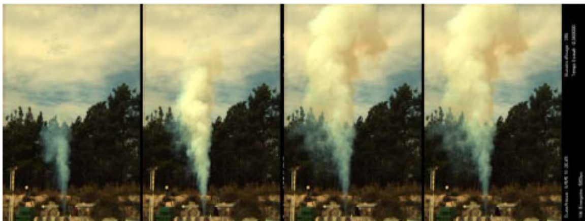
Figure 23 Visualisation par caméra rapide de l'éjection de produits à travers la brèche du bunker – panache de fumée diphasique
