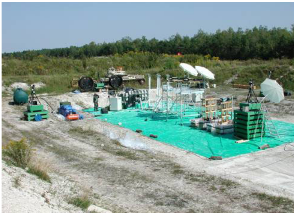
Figure 16 Vue générale du dispositif expérimental lors des tirs réalisés sur le site de Mourmelon - dispositif de caractérisation du nuage éjecté du bunker
