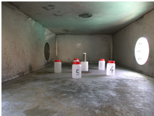
Figure B 1 A gauche, Vue interne du bunker – charge à éclats entourée de containers, à droite, containers alignés le long d'une paroi
