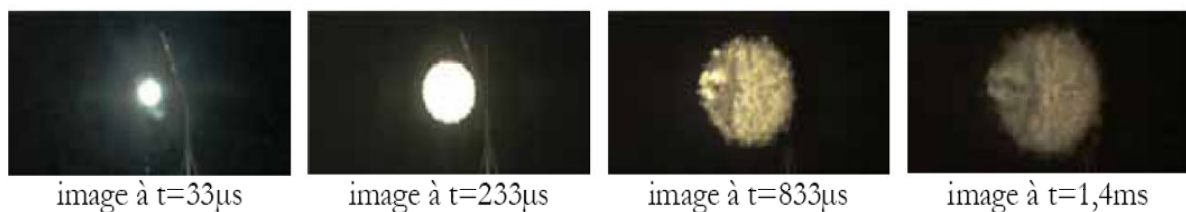
Figure C1 Extraction vidéo – développement de la boule de feu des produits de détonation d'un explosif secondaire
