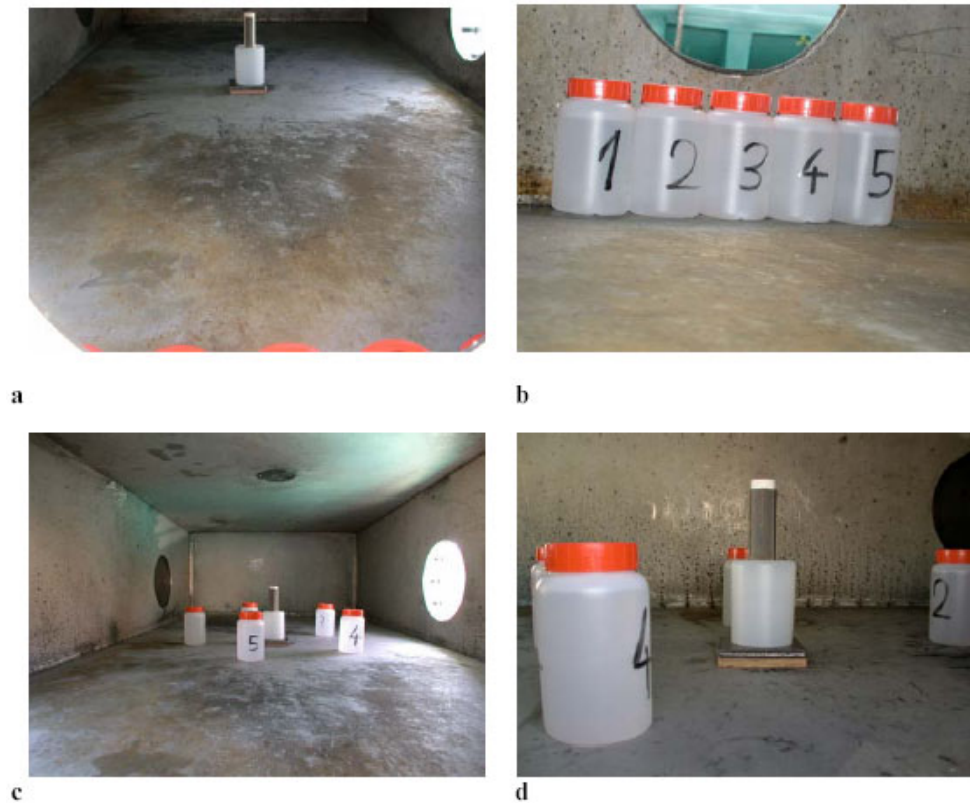
Figure 14 Vues des deux dispositions initiales étudiées – en haut, alignement des containers le long d'un mur - en bas, disposition concentrique.
