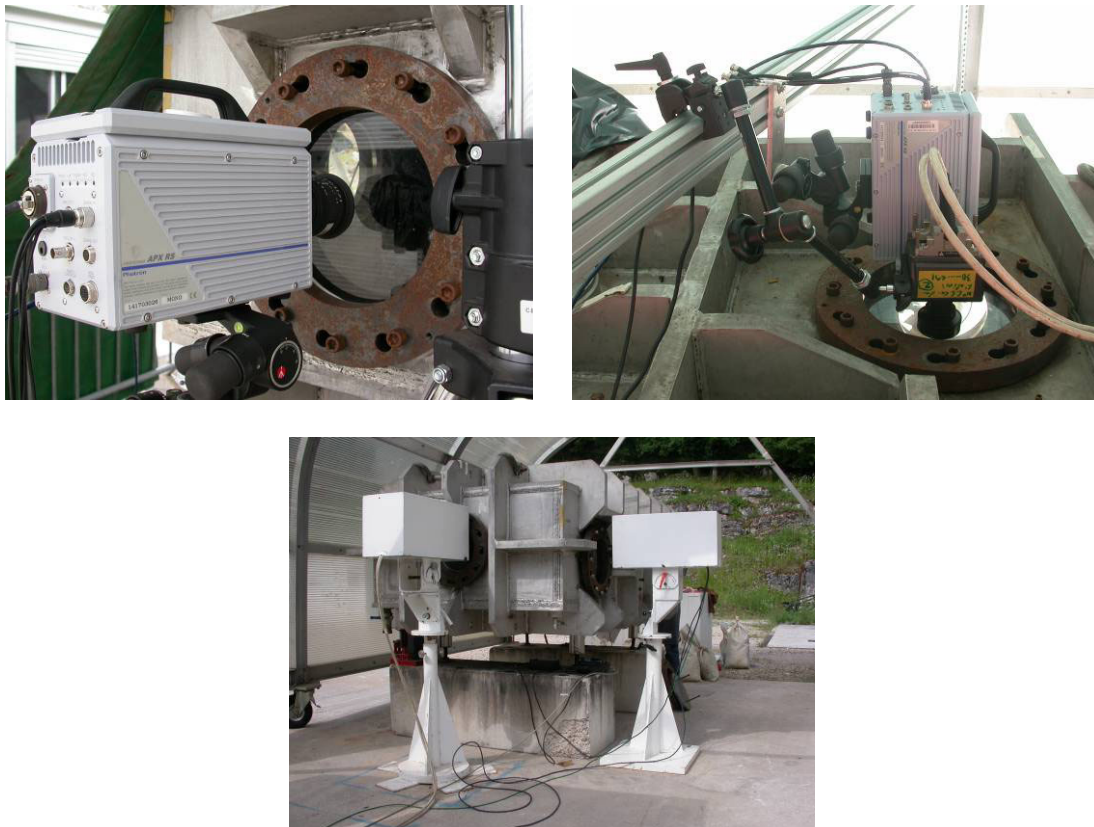
Figure B17 Système de visualisation numérique ultrarapide – mise en place de 3 caméras couleur Photron Fast Cam – Gauche : vue latérale – droite : vue supérieure – milieu : vue de face et vue latérale
