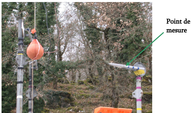
Figure C3 Sonde « stylo » à 1 mètre de la charge
