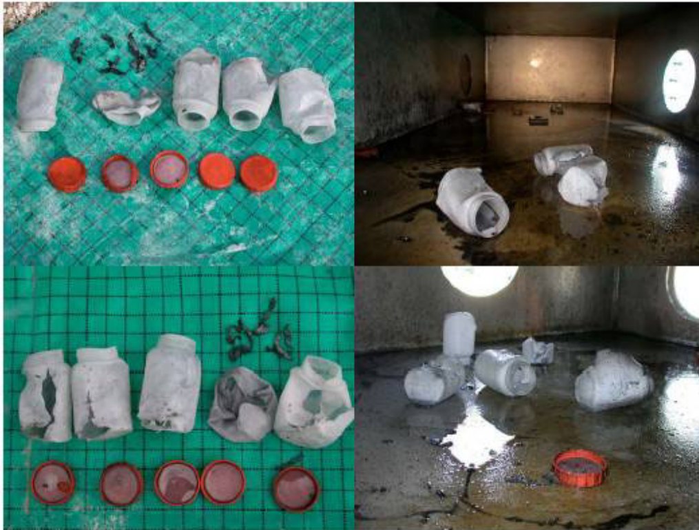
Figure 20 Etat résiduel de l'enceinte après essai et faciès d'ouverture des bidons en plastiques – on note la présence de liquide et de résidus noirs sur les parois
