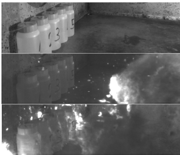
Figure 18 Impact de fragments et ouverture de bidons alignés
