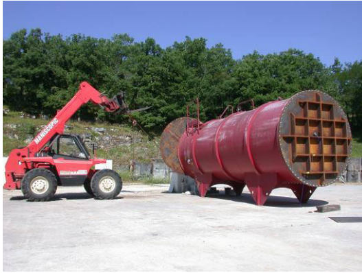
Figure B11 Vues extérieures de la chambre Sirocco 33 m 3 – Mise en place des tapes de fermeture
