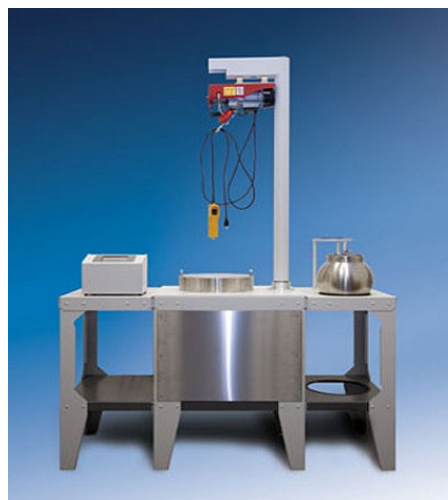
Figure IV.1 Calorimètre de détonation du CEA Gramat
