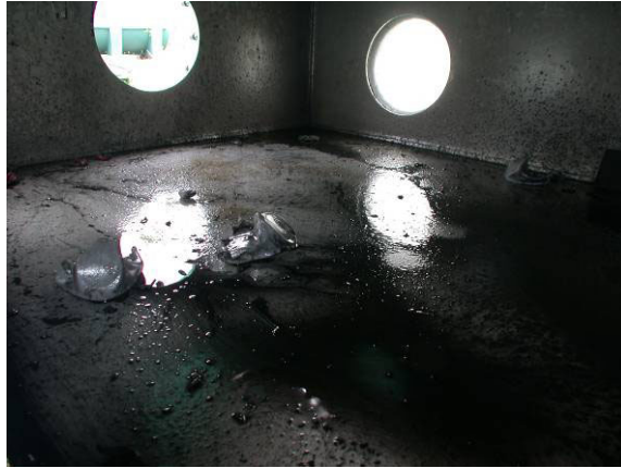
Figure IV.4 Résidus visqueux à l'issu d'un essai explosif + TMP dans le bunker du CEA Gramat
