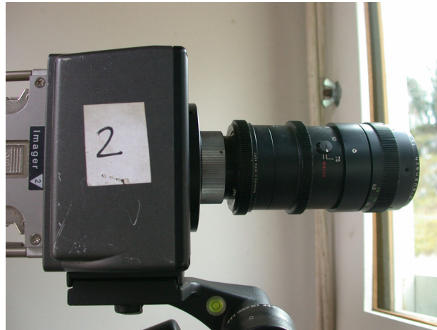
Figure C5 Tête optique déportée dans sa casemate de protection pour visualisation de l'explosion
