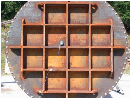
Figure B12 Gauche : tpe de fermeture et capteur de pression pariétal – droite : mise en place d'une charge cylindrique au centre de la chambre
