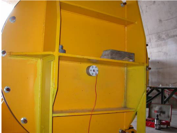
Figure B9 Implantation d'un capteur de pression sur une tpe de fermeture de la chambre Athéna
