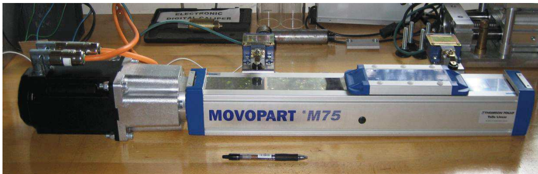
Fig.3.8 : Photos de la platine de déplacement linéaire.
