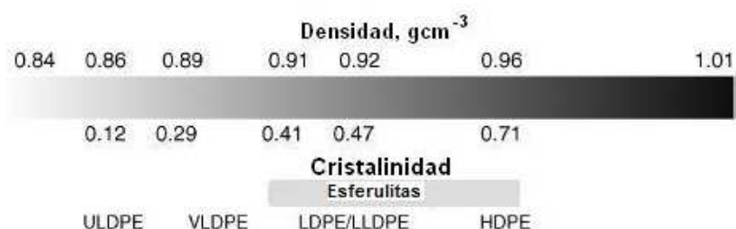
Fig. 1.1: Escala de rangos de densidad y cristalinidad para tipos de PE [32]
