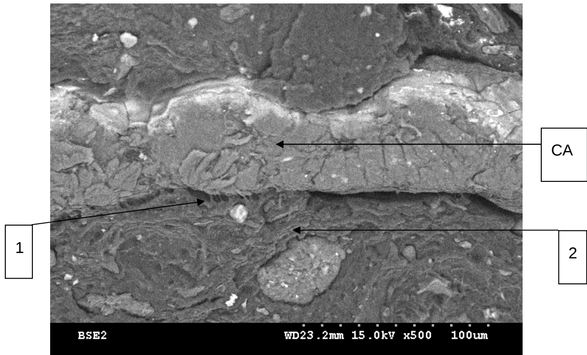
Fig. 3.9: Imagen SEM de mezcla de plásticos con cáscara de arroz: 70 (Mezcla)/ 30 cáscara de arroz preparada por compresión.
