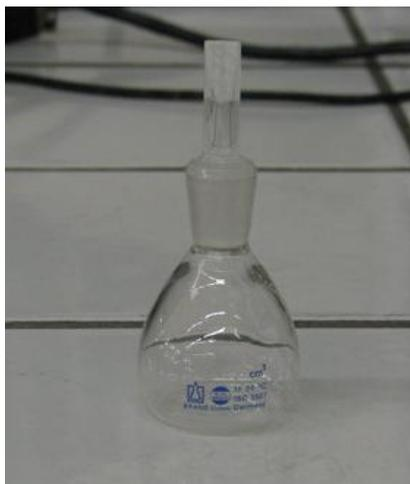
**Figure III.3 Pycnomètre**
