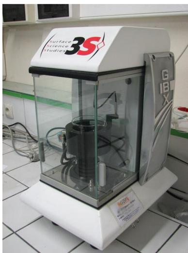
Figure III.1. Tensiomètre Digidrop GBX 3S®
