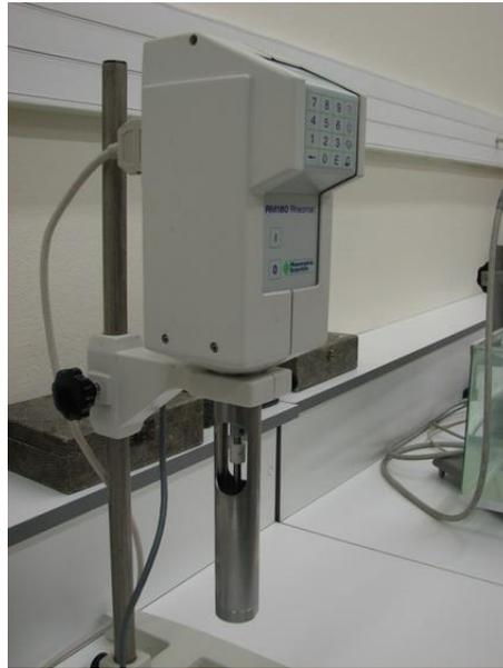
**Figure III.2. Rhéomètre RM180 Rheomat Rheometric Scientific®**
