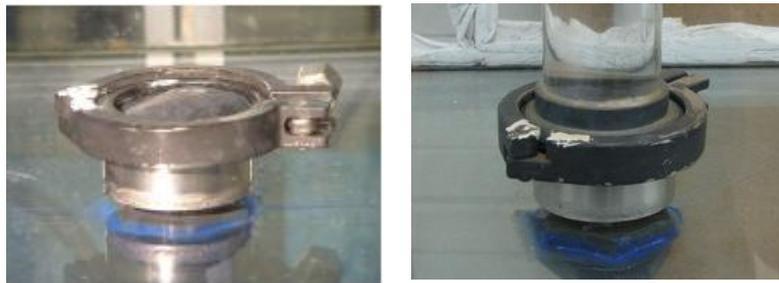
**Figure III.5. Fixation de la membrane – Clamp**
