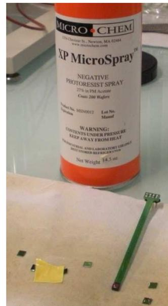
Figure 66 : Réalisation d'un dépôt de résine sur le capteur et les échantillons « témoin »
