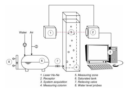
Figure (e) : système de mesure de taille des micro-bulles
