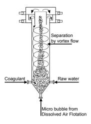
Figure (a) Principe de fonctionnement du procédé hybride
