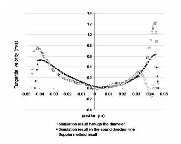
Figure (d) : comparaison des vitesses tangentielles obtenues dans l'hydrocyclone par les méthodes expérimentales et numériques
