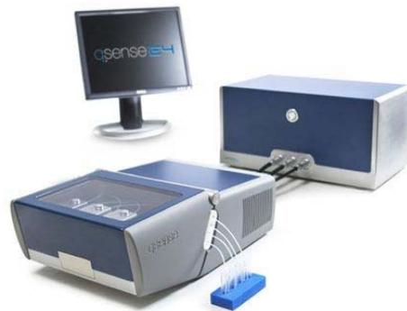
**Figure 24.** Image du système Quartz Crystal Microbalance – Dissipation (Q-SENSE E4). Ce système permet de faire des études comparatives de cinétiques de greffage biomoléculaire (sensibilité de l'ordre de 20 ng/cm<sup>2</sup>). Il contient 4 cellules fluidiques qui peuvent être utilisées en série ou en parallèle pour s'adapter à une large variété de protocoles expérimentaux.
