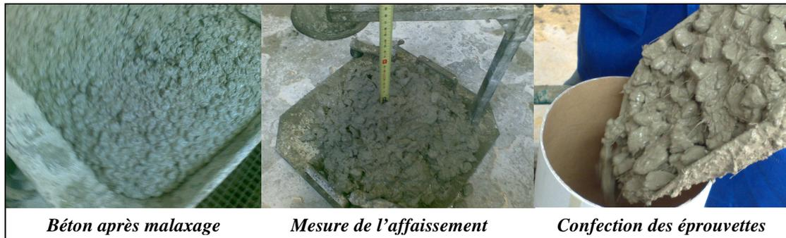
**figure 2.4.** *Fabrication des éprouvettes de béton.*
