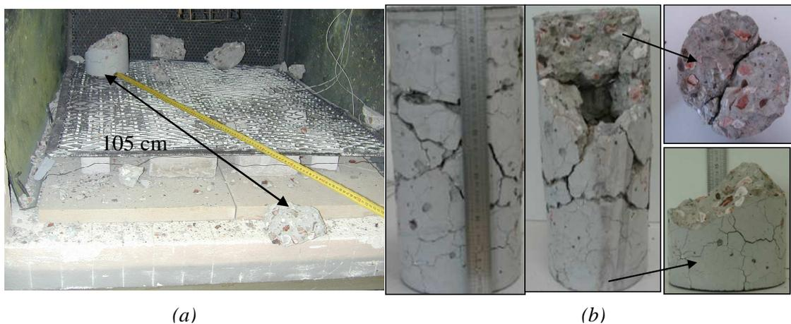
**figure 4.1.** Eclatement d'éprouvette de béton C3 conservée dans l'eau (a) et reconstitution de l'éprouvette à partir des morceaux résiduels (b).
