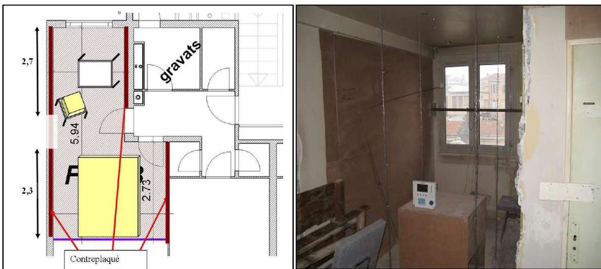
figure 7.2. Disposition du potentiel calorifique dans le local avant la mise à feu.
