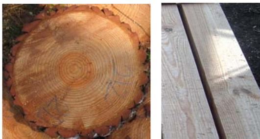
*Figure 10 : Pin maritime, Aspect du duramen sur disque et sur sciage*
