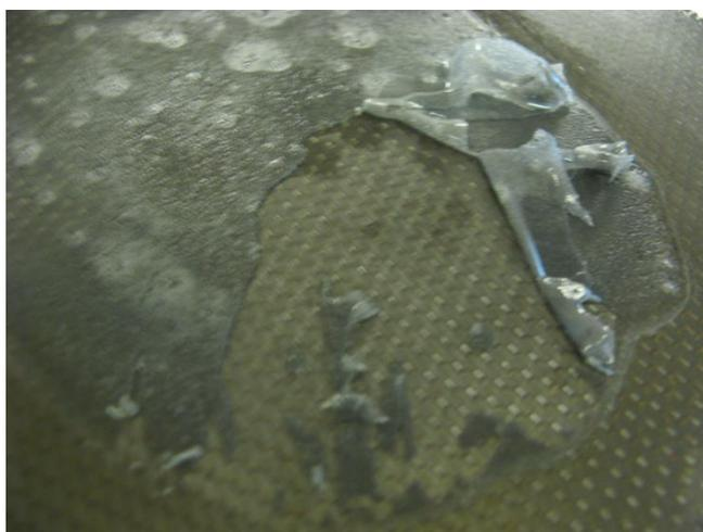
**Figure 116 : Pelage d'un film d'alginate de calcium non cohésif**
