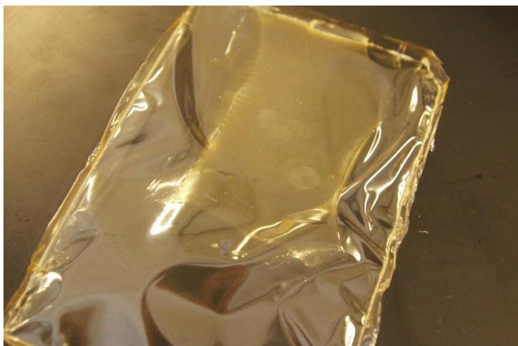
**Figure 64 : Film sec d'alginate de calcium hétérogène**
