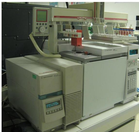
**Figure 30 : Appareillage de GCMS**
