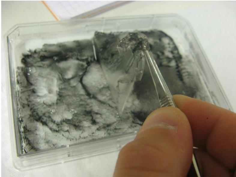
**Figure 111 : Pelage de la solution détergente appliquée par écoulement**
