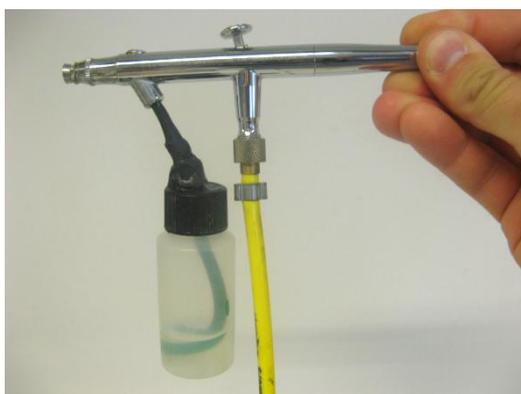
**Figure 27: Aérographe Iwata HP-BCR utilisé pour pulvériser le chlorure de calcium**
