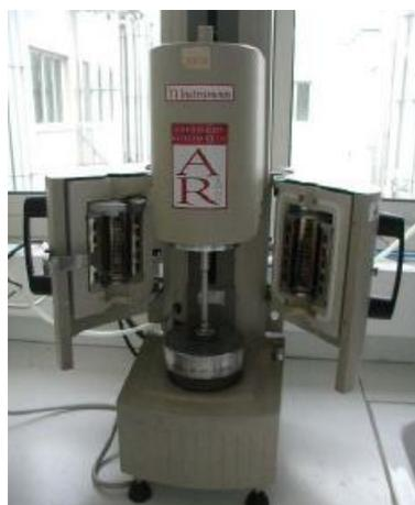
Figure 38 : Rhéomètre AR1000N
