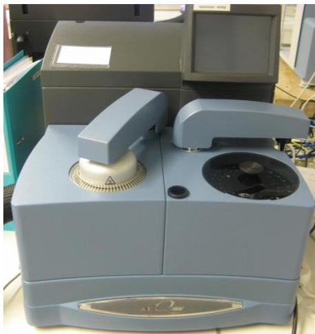
**Figure 33 : Appareillage de DSC**
