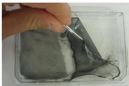
**Figure 117 : Procédé final de détergence des surfaces souillées**
