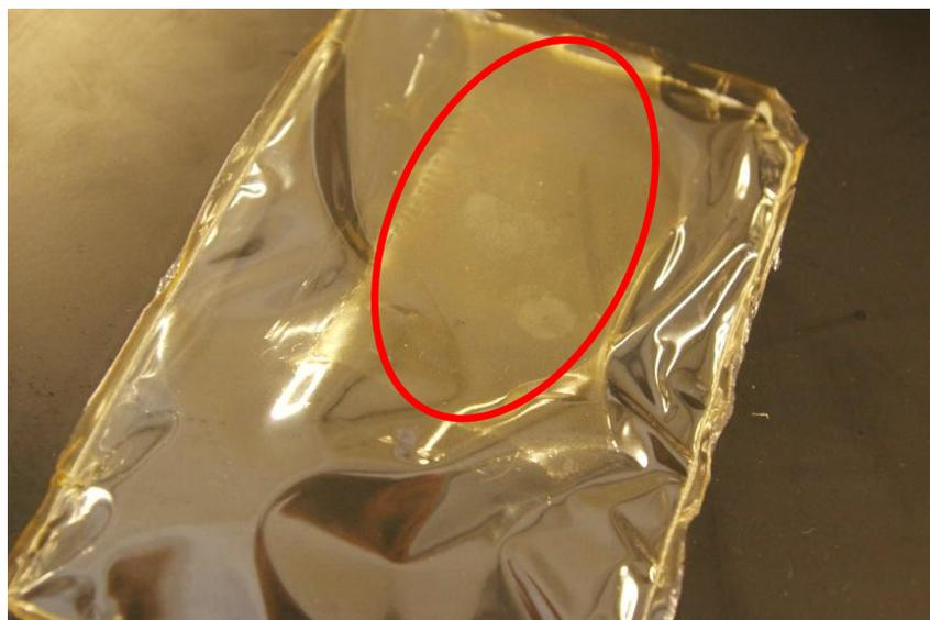
**Figure 88 : Zone de découpe des échantillons de traction.**
