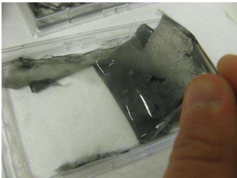
**Figure 113 : Pelage de la solution détergente appliquée au pinceau**
