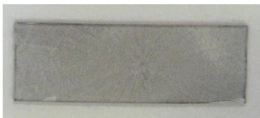
**Figure 104 : Lamelle souillée par spin-coating (4g/m<sup>2</sup>)**
