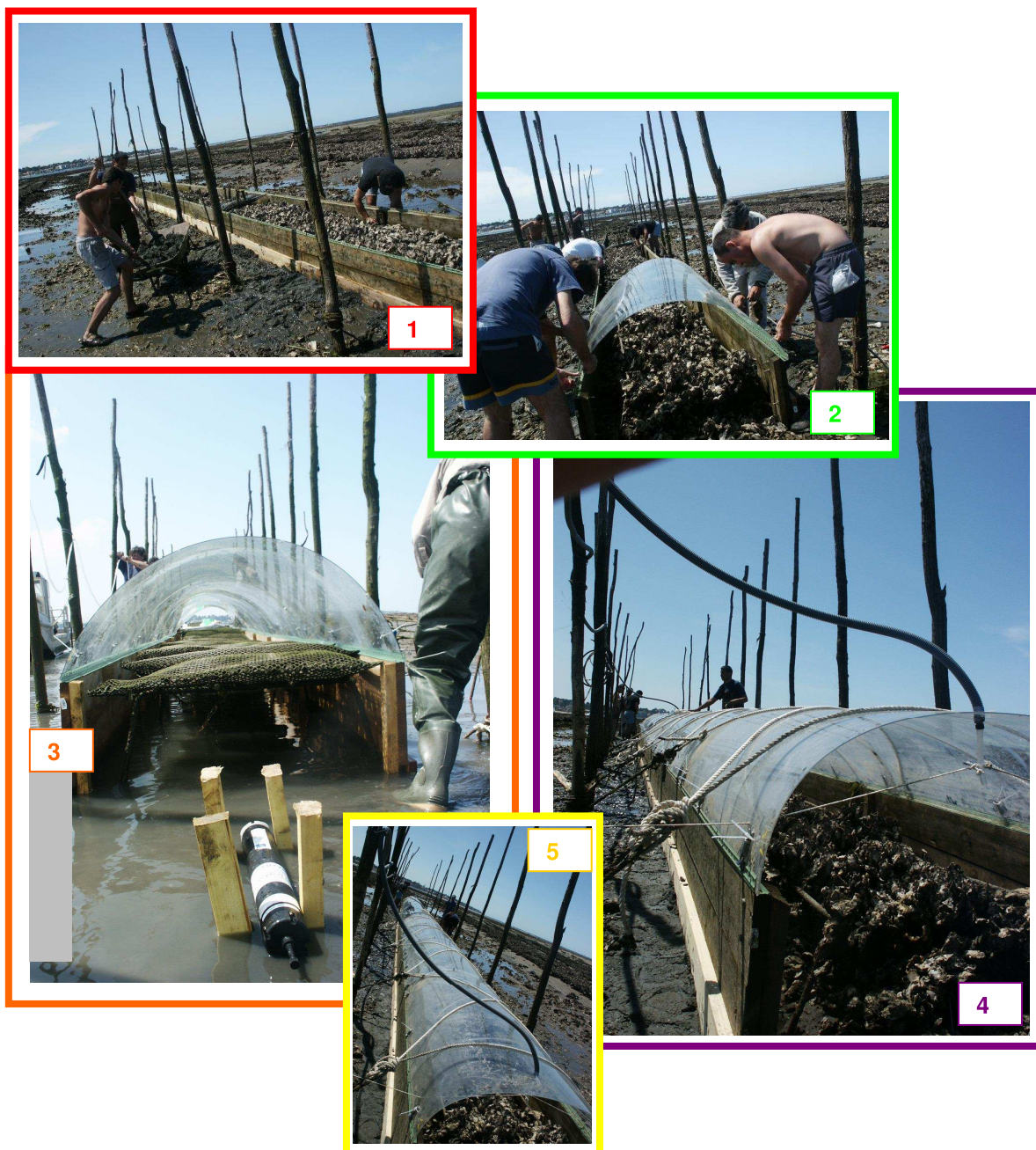
Figure IV-2 : Mise en place des tunnels benthiques au-dessus des récifs d'huîtres sauvages (1, 2, 4 et 5) et des huîtres cultivées sur tables (3). Le Profiler Aquapro est visible au premier plan sur la photographie 3 ; les tubulures du système de prélèvement d'eau sont observables sur les photos 4 et 5.
