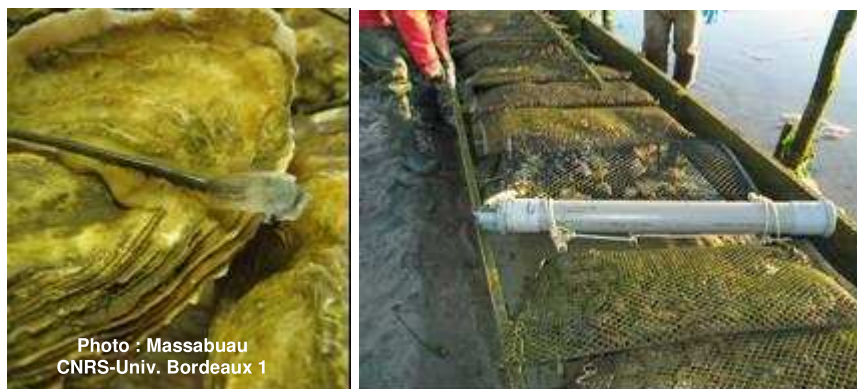
Figure IV-3 : Sonde valvométrique (à gauche) et mise en place sur le terrain (à droite) avec le système d'émission.
