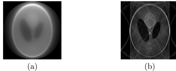
FIGURE 1.7: (a) Résultat de la reconstruction utilisant la transformée de Radon inverse. (b) Reconstruction de Fourier en utilisant le théorème de la tranche centrale.
