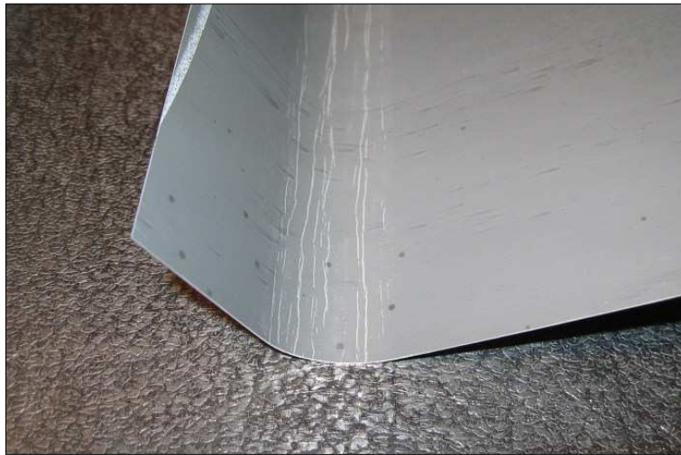
FIGURE 1.2 : Échantillon utilisé pour le contrôle d'adhérence.
