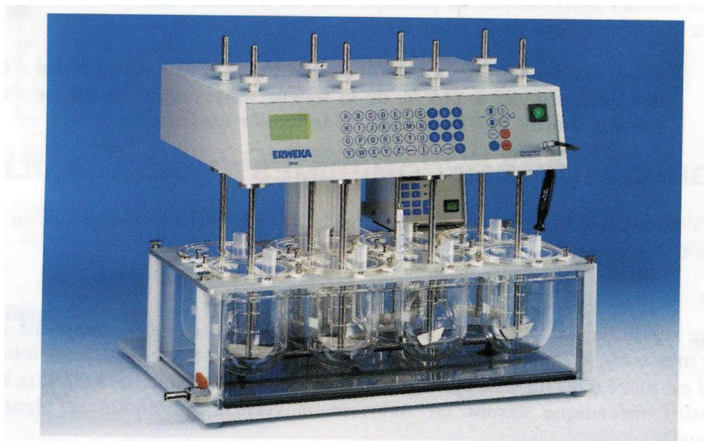
Figure 30 : appareil de contrôle de dissolution : système à palettes<sup>196</sup>
