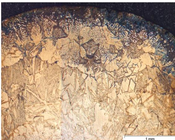
Figure 4.11– Micrographie optique de l'échantillon  $\text{Er}_{40}\text{Zr}_{60}$  brut de fusion
