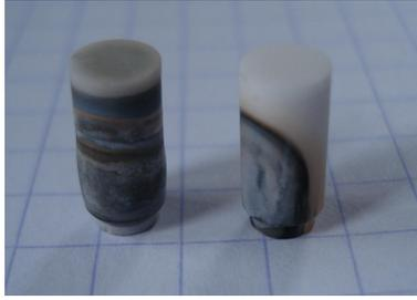
**Figure 4.22**– Photographie de creusets en  $Y_2O_3$  ayant servis à l'ATD d'un échantillon de composition  $Er_{65}Zr_{35}$ . *Le creuset de gauche est le creuset échantillon et celui de droite le creuset référence. La vaporisation d'erbium a conduit à une pollution des parois des deux creusets*
