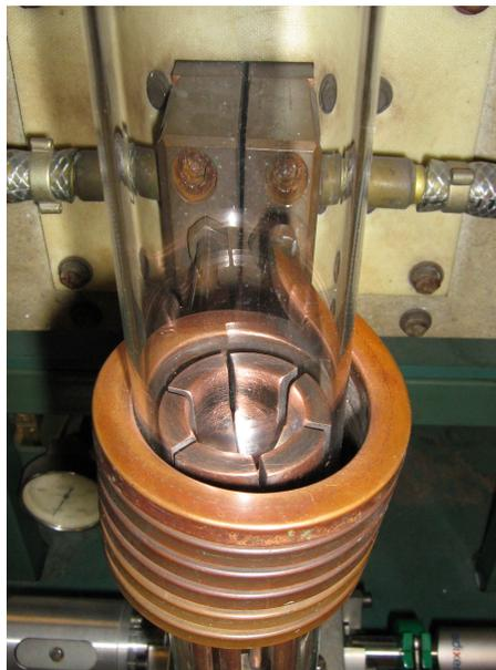
Figure 2.5– Photographie du creuset utilisé pour la fusion à induction
