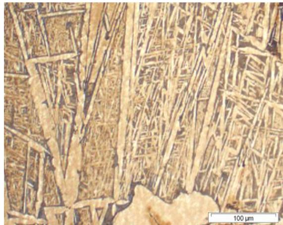
Figure 4.15– Micrographie optique de l'échantillon  $Er_{40}Zr_{60}$  brut de fusion
