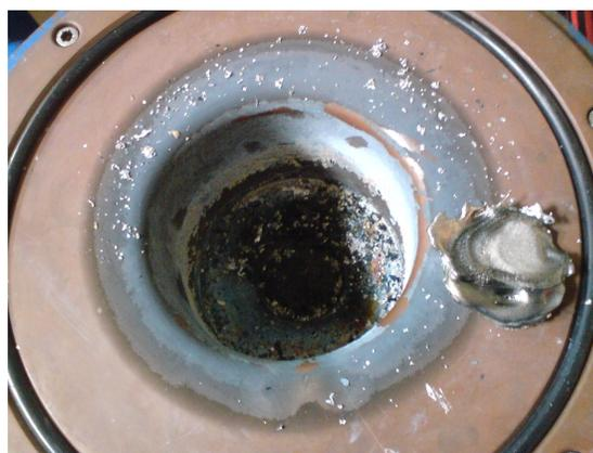
Figure 5.5– Photographie du creuset du four à arc du CEA/LTMEx après une tentative de fusion de l'échantillon de composition  $\text{Er}_{12}\text{O}_8\text{Zr}_{80}$ . À l'approche de l'arc électrique, une réaction exothermique a provoqué l'explosion de l'échantillon
