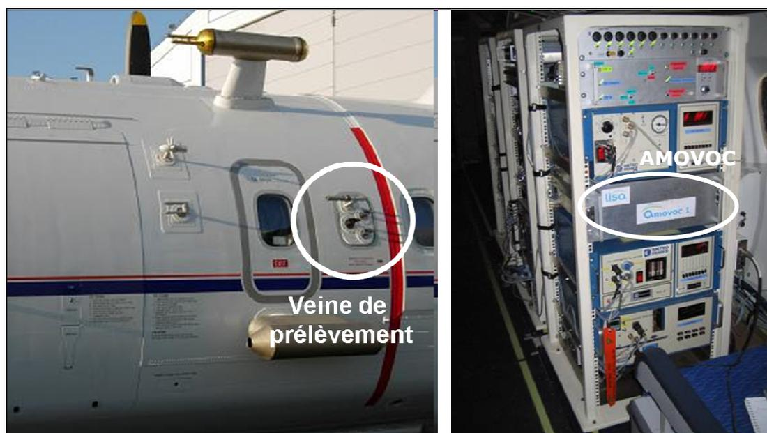
Figure II- 13 : Photographie de la veine de prélèvement de l'ATR-42 (gauche) et de AMOVOC embarqué sur la baie chimie de l'ATR-42 (droite) durant la campagne AMMA
