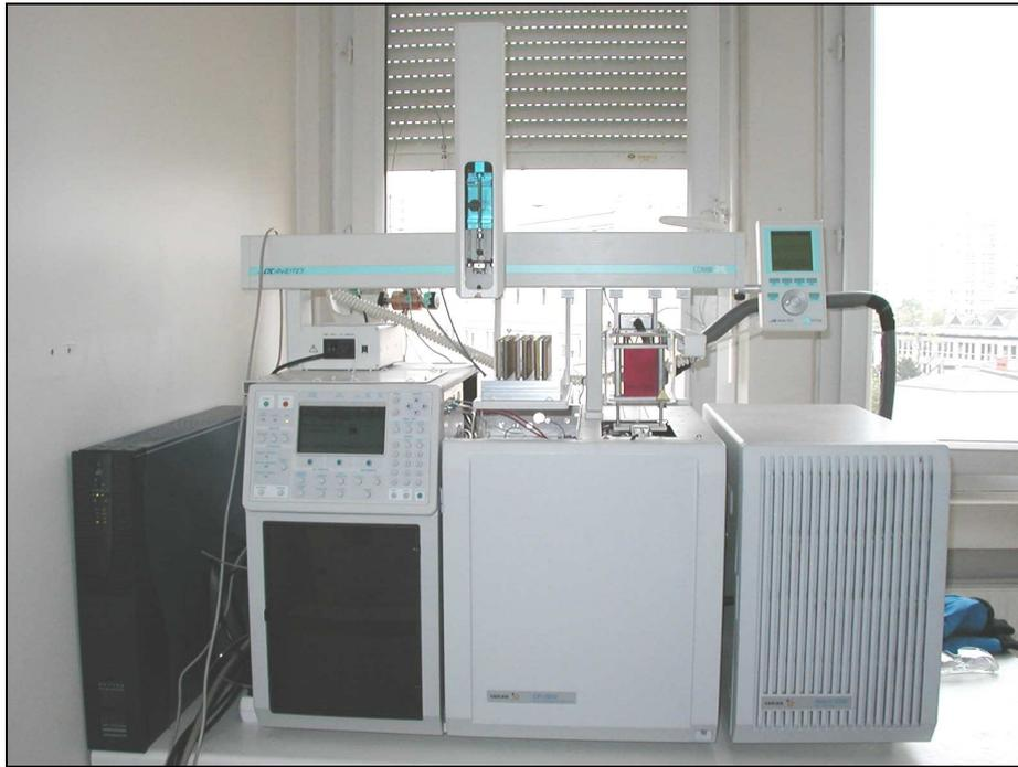
Figure II- 10 : Le système analytique CombiPAL-TDAS-GC/MS
