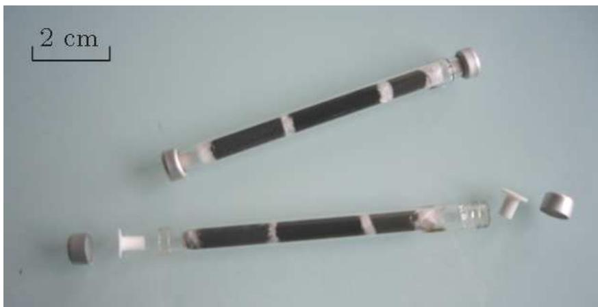
Figure II- 11 : Photographie des cartouches d'adsorbant
