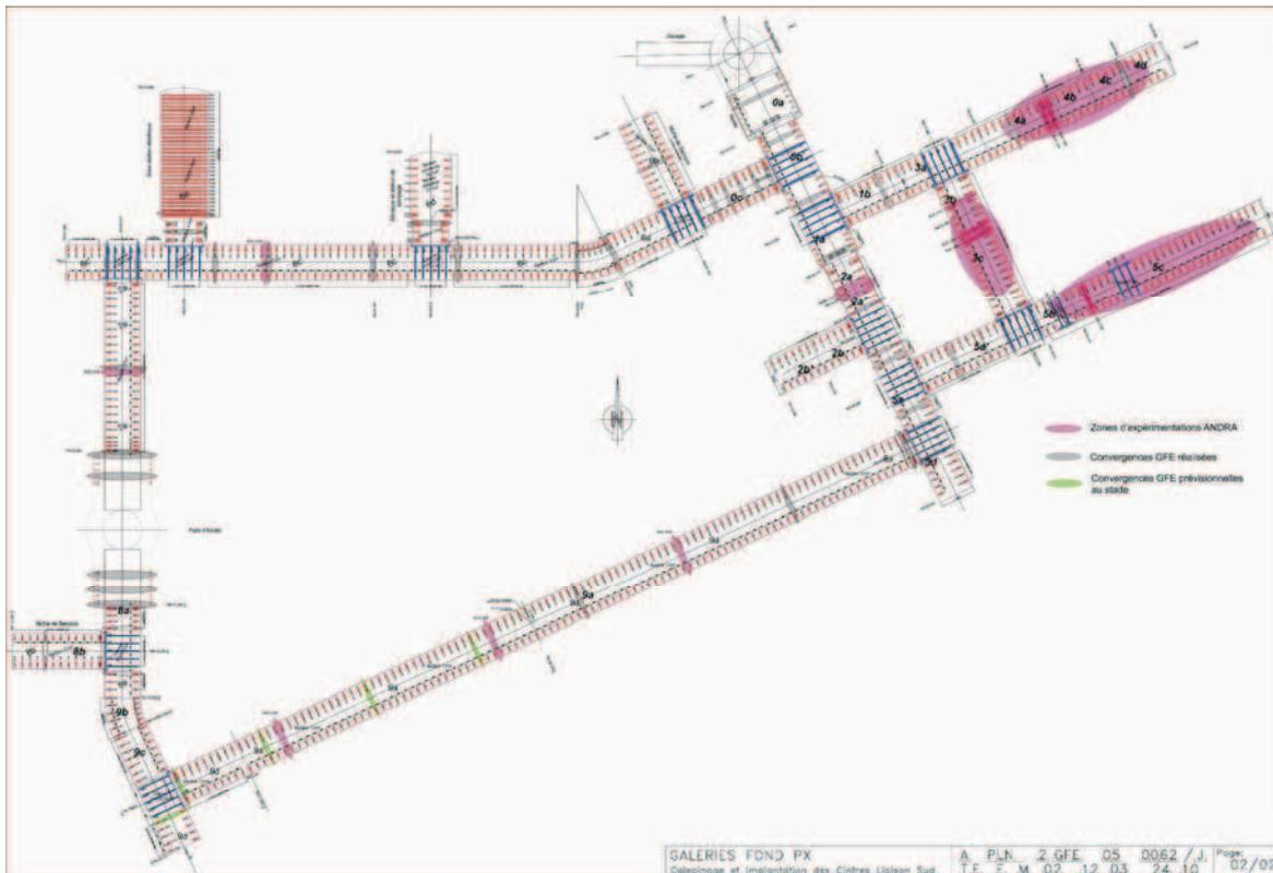
Figure 6. Plan des galeries du laboratoire souterrain (-490 m) avec les zones d'expérimentation en mauve (OIEDZ, Géomécafor)
