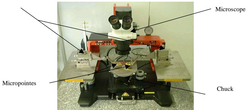
**Figure 5.14 :** Testeur sous pointes Karl Suss PM 5
