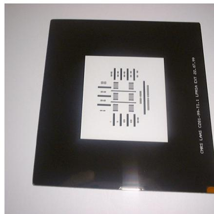
**Figure 2.11** : Exemple de masques utilisés pour la réalisation des dispositifs à ondes acoustiques de surface (SAW)
