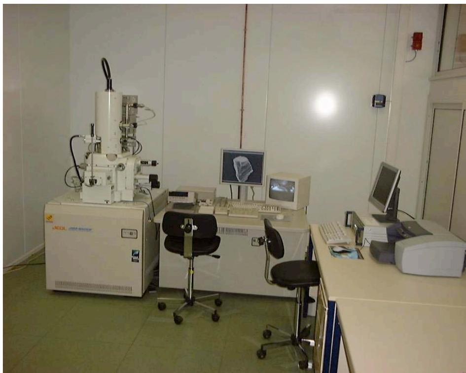
**Figure 4.14 :** Photo du microscope électronique a effet de champ.
