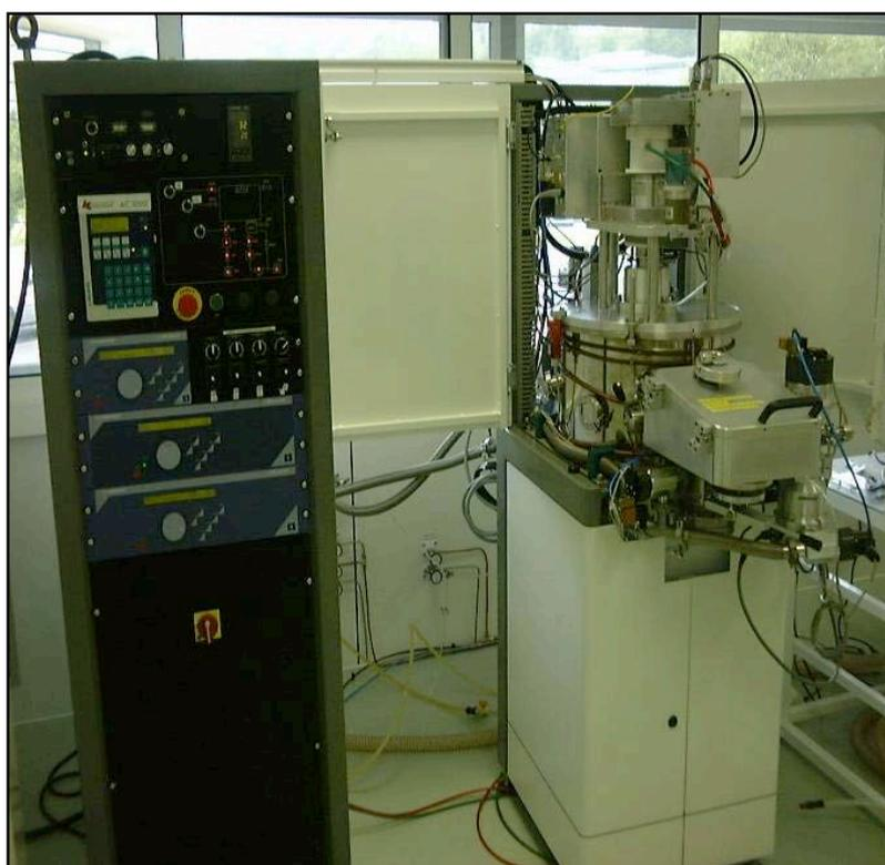
**Figure 4.3** : Système de pulvérisation magnétron (ac450)
