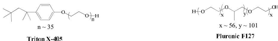
**Figure III.11.** Formules des tensioactifs Triton X-405 et Pluronic F-127
