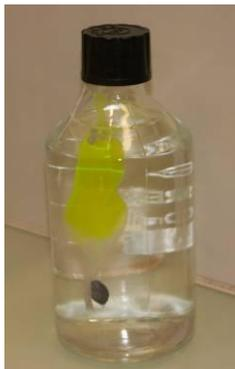
**Figure 17.** Photo du dispositif de dialyse. Le sac à dialyse est ici rempli de fluorescéine, le plomb utilisé sur la photo s'est avéré inutile pour garder le sac vertical et n'a pas été utilisé dans les expériences avec les contaminants.
