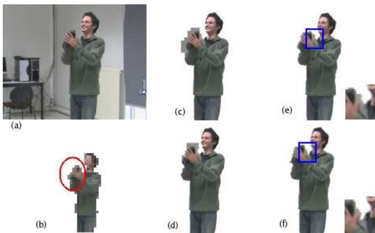
Fig. 5.8 – (a) Image originale, “Vincent”, LaBRI (b) Résultat de la segmentation à BR (grossi x3) (c) Segmentation morphologique LL (d) Segmentation morphologique HF (e) Régularisation markovienne classique (f) Régularisation markovienne HF
