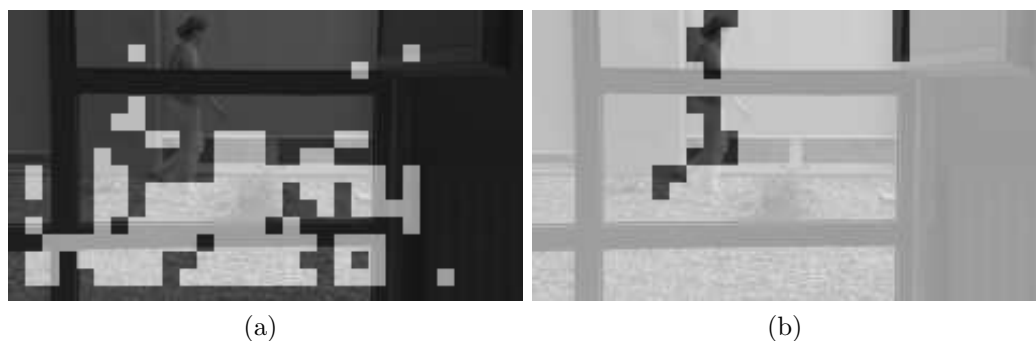
Fig. 4.7 – Blocs dont le vecteur de mouvement est “non conforme” au modèle de mouvement global (a) avant et (b) après correction par critère de qualité basé MAD
