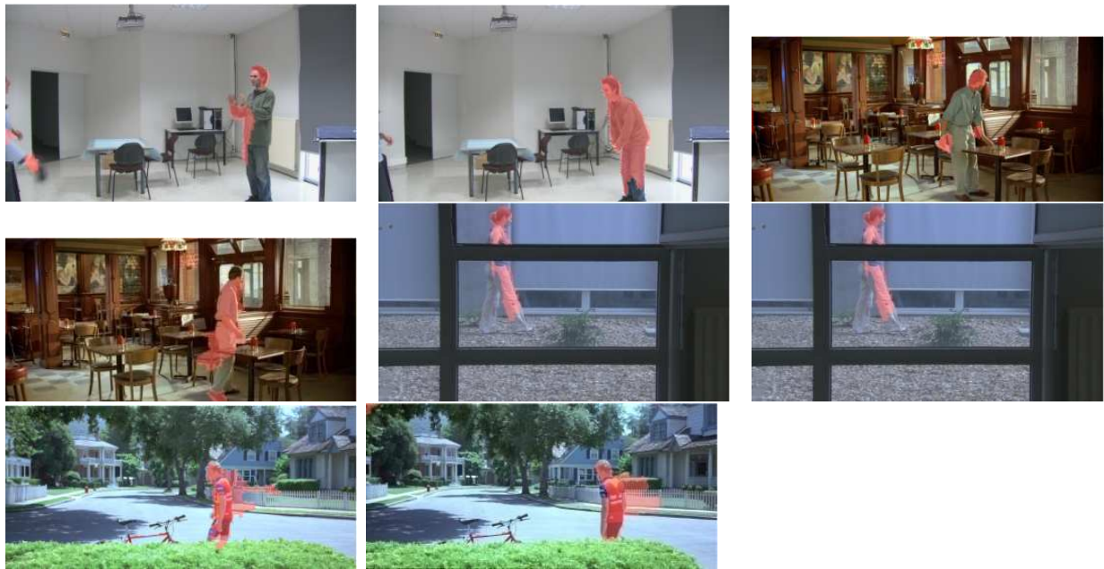
Fig. 5.11 – Exemples de résultats d’extraction d’objets obtenus avec notre méthode utilisant l’ajustement markovien
