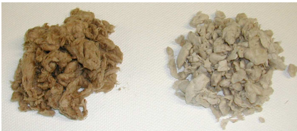
Figure 75 : Photographies de pâtes issues d'une cuisson après préhydrolyse (à gauche) et d'une pâte témoin (à droite)
