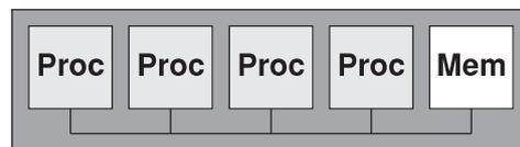
FIGURE 2.11 – Exemple d'architecture SMP.
