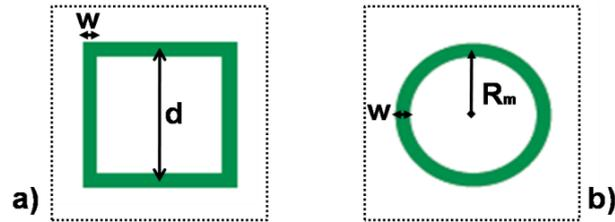
Figure 2-18. Les motifs inductifs boucle carré (a) et boucle circulaire (b):
