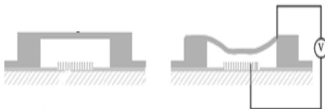
**Figure 1-21. Principe de fonctionnement d'un MEMS pont à air à commande électrique.**
