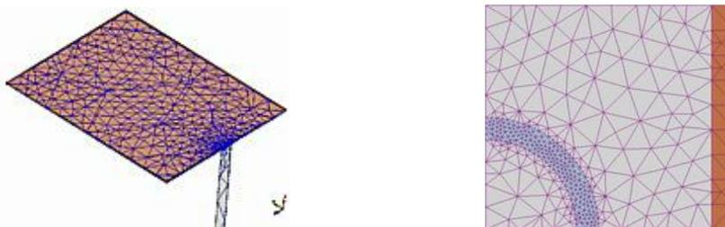
Figure 2-7. Exemples de maillages adaptatifs utilisés en FEM.
