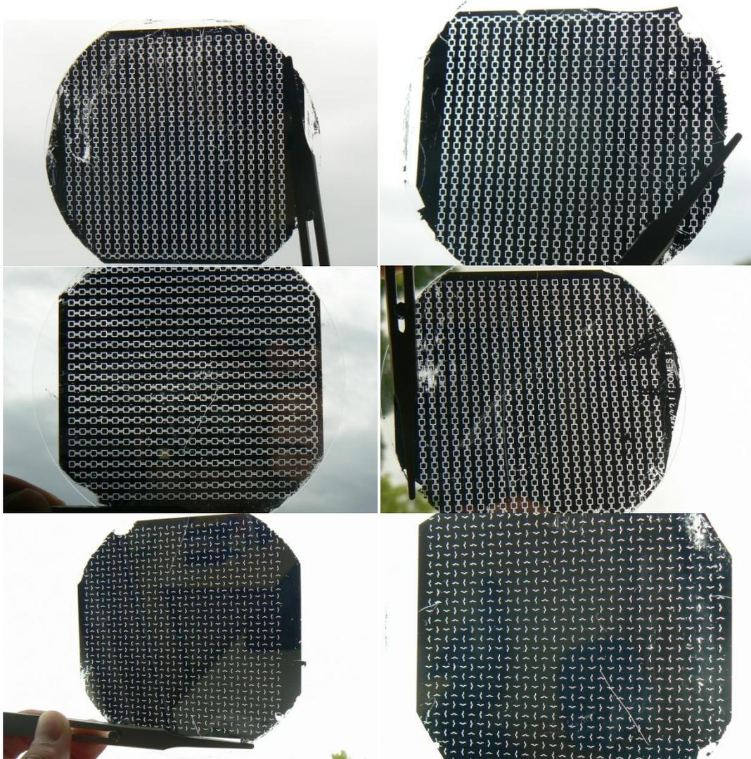
Figure 4-11. Photographies des structures réalisées par photolithographie.
