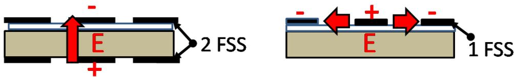
Figure 3-17. Comparaison de l'application du champ électrique pour les deux structures multicouches envisagées (métal en noir, substrat en gris et matériau accordable en blanc).
