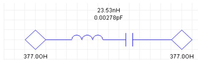
Figure 2-36. Circuit équivalent d'une FSS en espace libre dans l'air.
