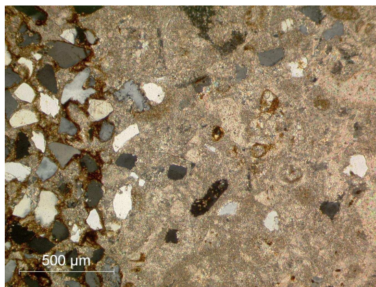
Figure 2.8. Détail de la Figure 2.6 B. Limite de sédimentation entre le substrat dur (à droite) et les passées gréso-argiloferrugineuses (à gauche). Observation au MOP (LPA) ; (photo LRMH in LASTENNET et al., 2009).
